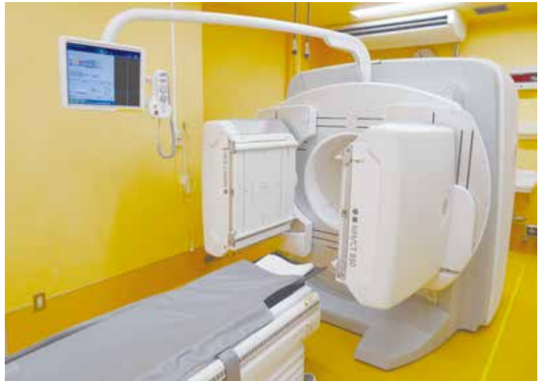
図1. SPECT/CT装置 NM/CT 850
